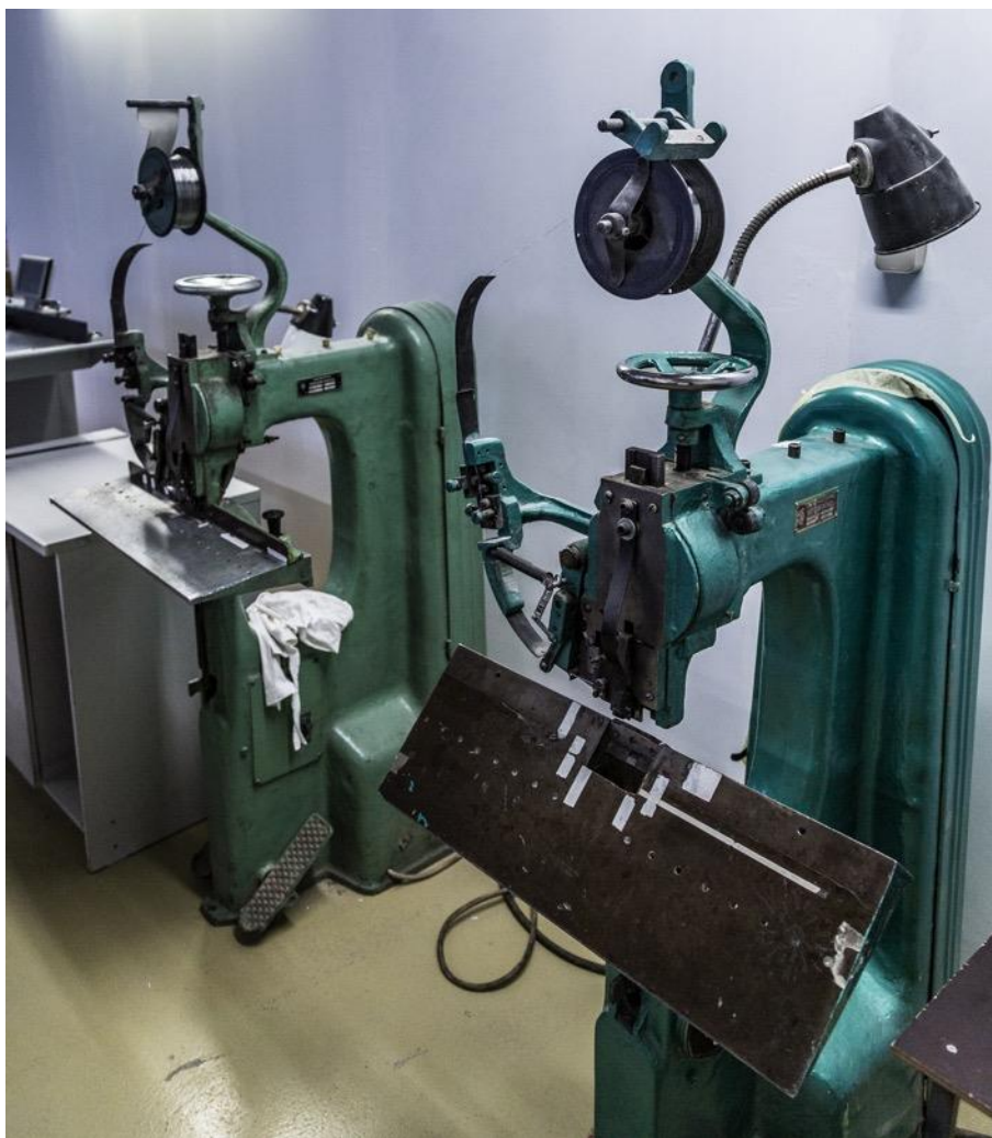
1.252. attēls. Manuāli vadāma skavošanas iekārta
