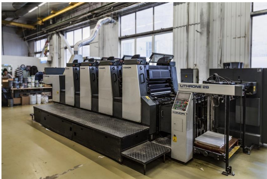
1.236. attēls. Ofseta drukas iekārta ar četrām sekcijām
