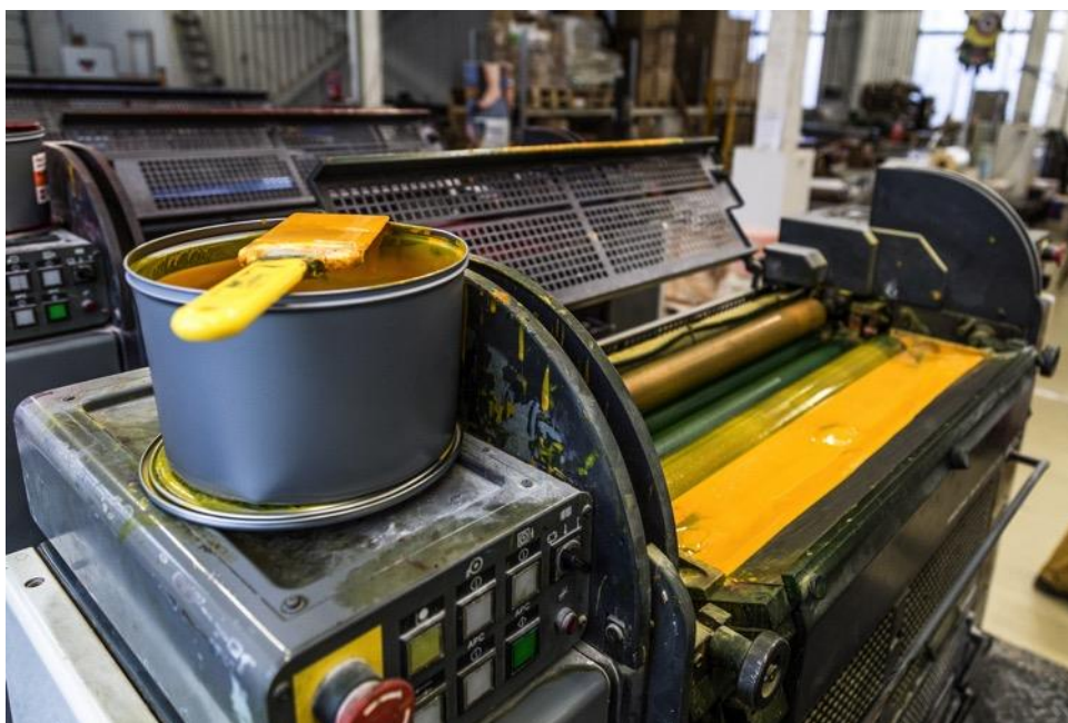
1.238. attēls. Ofseta drukas iekārtas sekcija, kurā iepildīta dzeltenā krāsa
